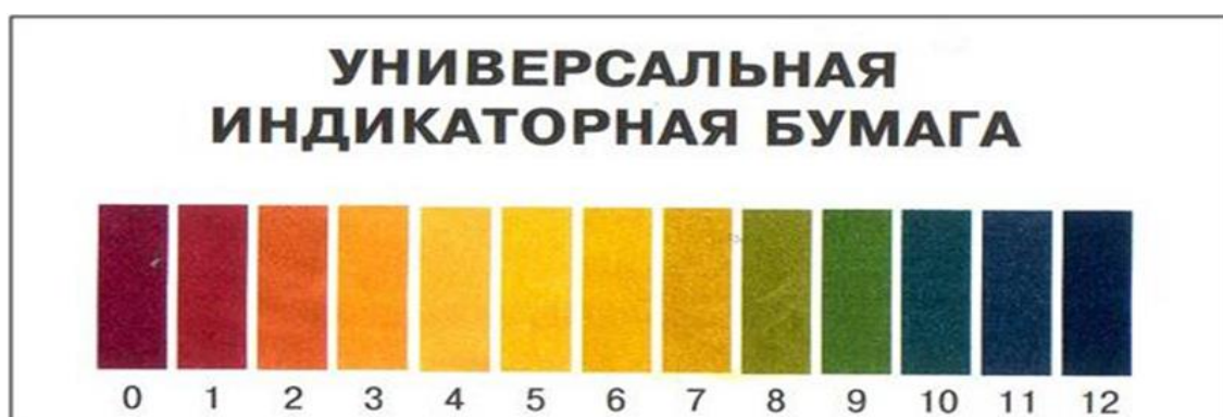
Рисунок 2.2.9.1 - Эталонная шкала рН (водородный показатель)
