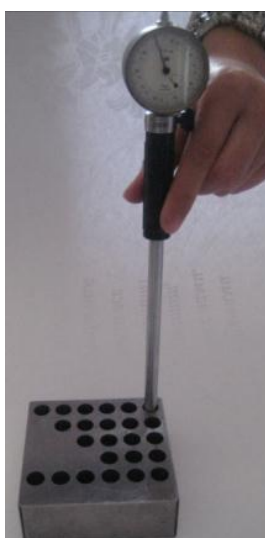
Рисунок 2.7 – Контроль качества допуска
