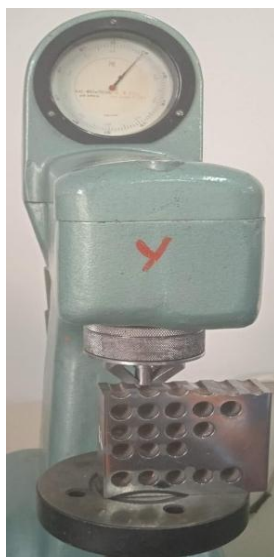
Рисунок 2.12 – Измерение твердости обработанной сверлением поверхности
