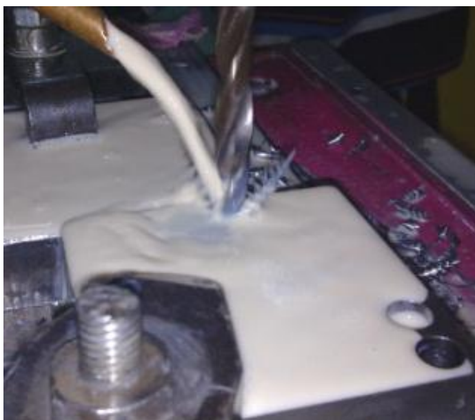
Рисунок 2.2 – Установка обрабатываемой заготовки непосредственно на столе станка
