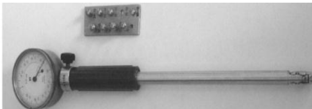
Рисунок 2.8 – Нутромер индикаторный НИ-10-18-1, 10 – 18 мм
