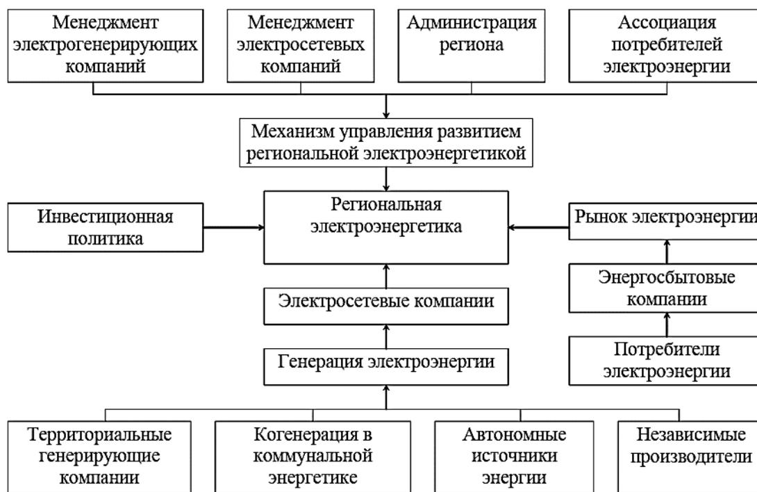
**Рисунок 1.8. Схема модели управления развитием энергетики [27]**
