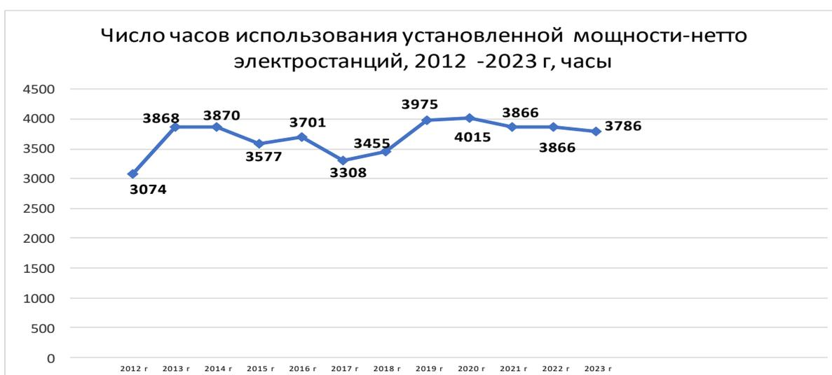
**Рисунок 2.7. Число часов использование установленной мощности-нетто электростанций за 201-2023 гг.**
