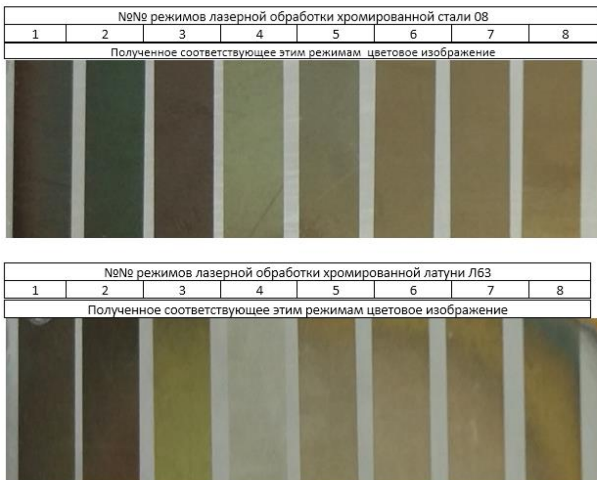
Рисунок 4.1 – Воспроизведение цветовых изображений, полученных в соответствии с различными режимами лазерной маркировки на хромированных поверхностях стали 08 и латуни Л63, снятых под углом 90°
