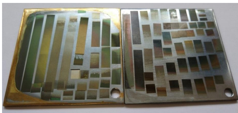
Рисунок 2.10 – Результаты тестовой обработки опытных хромированных пластин
