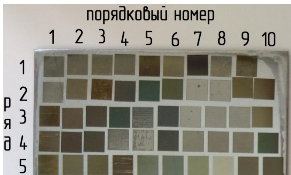
Рисунок 2.12 – Получение воспроизводимых цветовых изображений на хромированной поверхности стали 08
