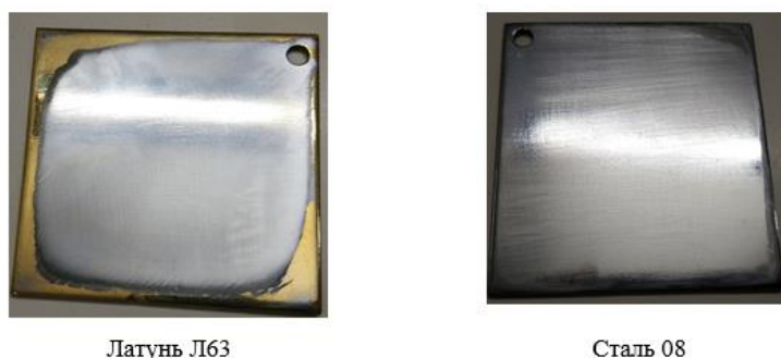
Рисунок 2.9. – Образцы после операции хромирования
