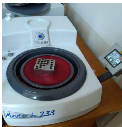
Рисунок 2.8 - Процесс полирования на полировочном установке «PRESI Mintech 233» со специальным материалом.
