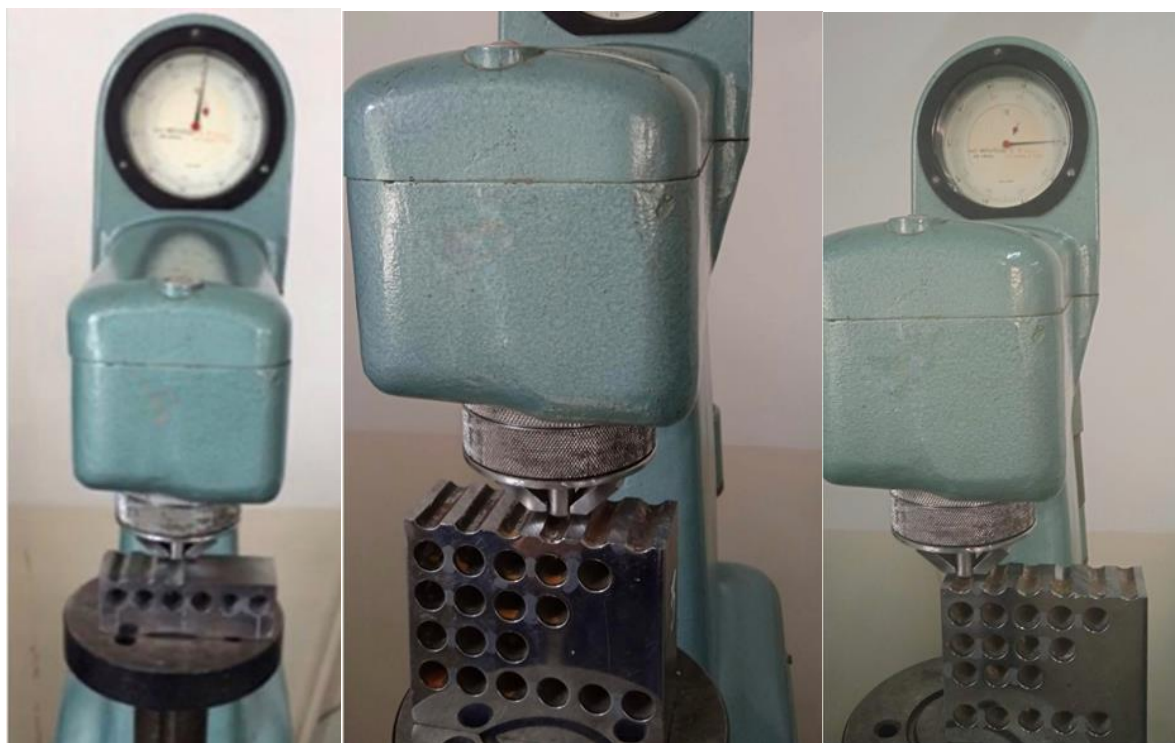
Рисунок 2. 18 – Измерение твердости поверхности, обработанной сверлением
