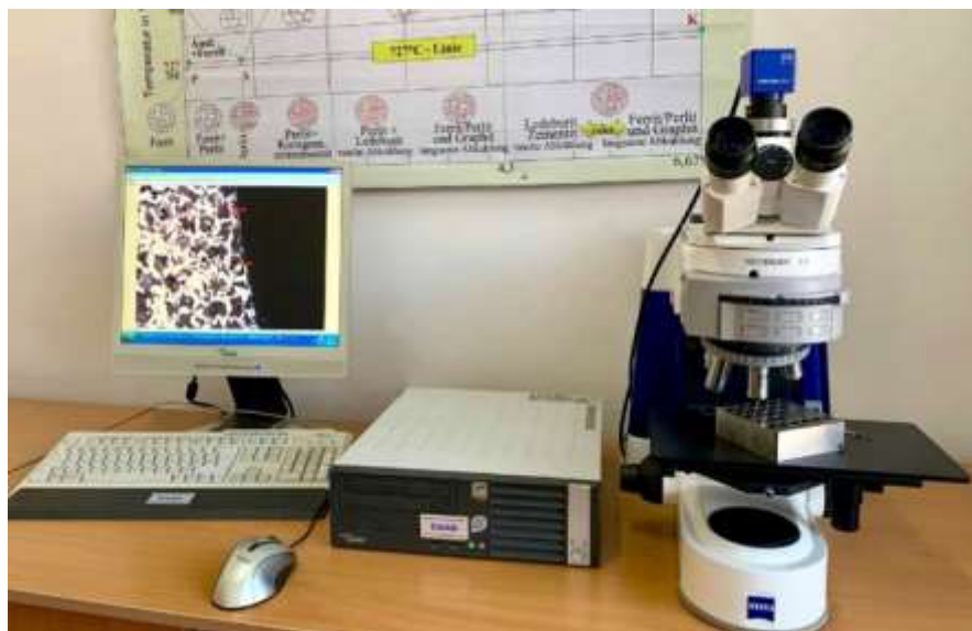
Рисунок 2.3 - Световой микроскоп Axio Imager A1m/M1m
