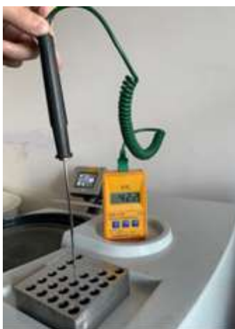
Рисунок 2.9 - Замер температуры поверхностного слоя с помощью цифрового термометра Greisinger GTN 1170
