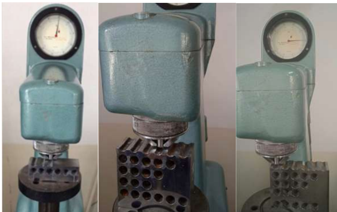
Рисунок 2. 18 – Измерение твердости поверхности, обработанной сверлением
