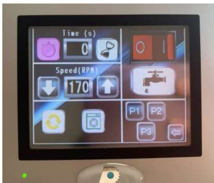
Рисунок 2.6 - Сенсорный дисплей шлифовально-полировочной установки « PRESI Mintech 233»
