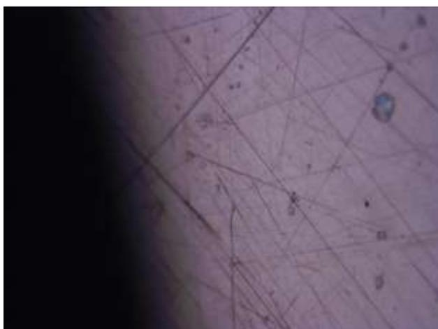
Рисунок 2.11 - Поверхность, наблюдаемая на окуляре металлографического микроскопа Axio Imager A1m/M1m образца после полирования, при увеличении  $\times 200$
