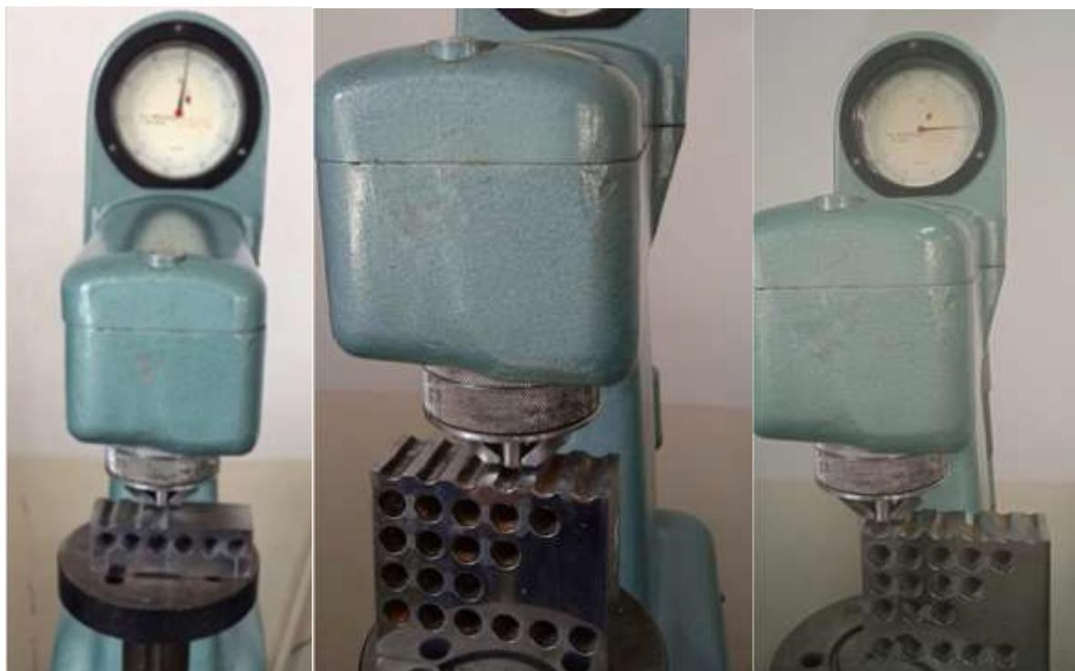
Рисунок 2. 18 – Измерение твердости поверхности, обработанной сверлением
