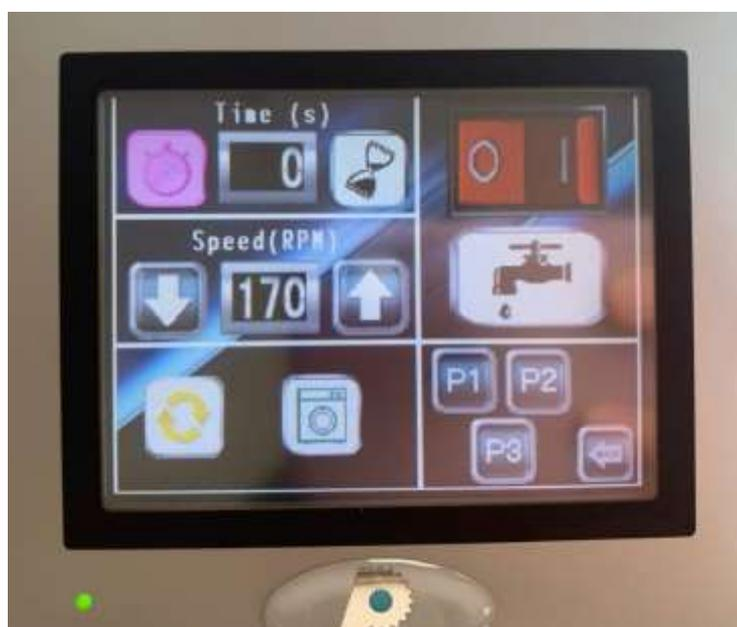
Рисунок 2.6 - Сенсорный дисплей шлифовально - полировочной установки « PRESI Mintech 233»
