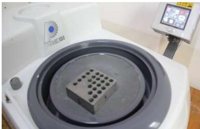
Рисунок 2.5 - Шлифовально - полировочная установка « PRESI Mintech 233»
