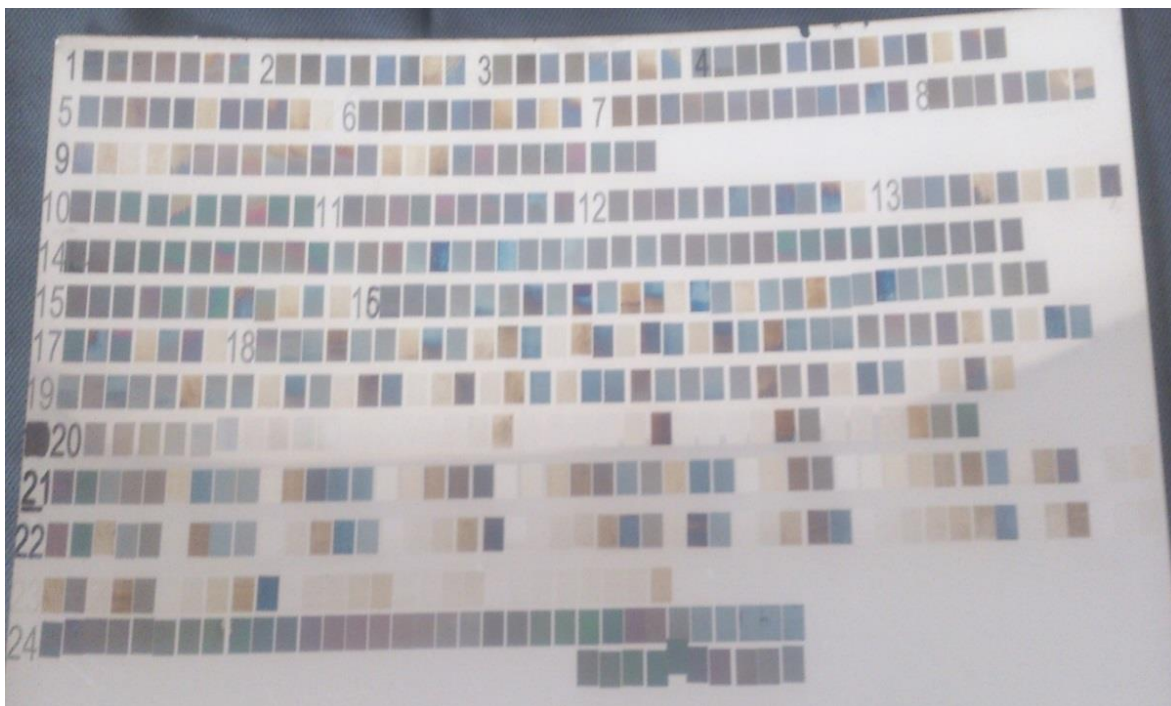
Рисунок 2.7. – Цветная лазерная маркировка на пластине с измененными параметрами
