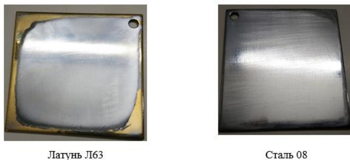
Рисунок 2.9. – Образцы после операции хромирования
