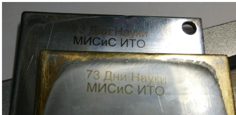
Рисунок 2.11. – Лазерная цветная маркировка хромистого покрытия на латунной и стальной пластинах
