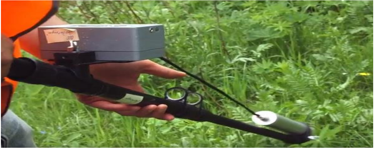
3.2.1.- сүрөт.СРП-68-01 дозиметр-радиометрин колдонуу менен гамма-нурланууну өлчөө
