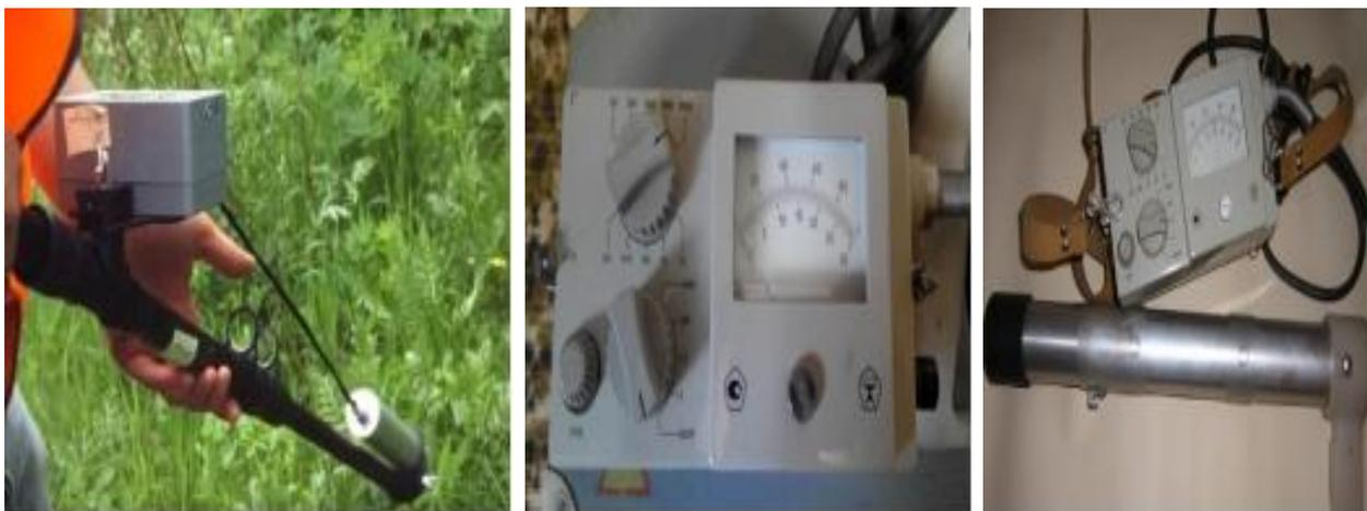
Рисунок 3.1.2 - Дозиметр СРП-68-01
