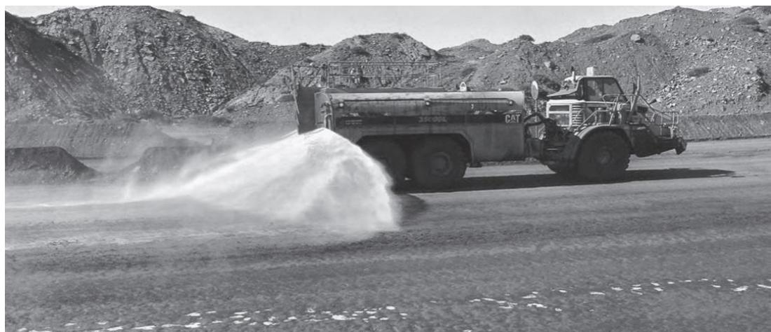
**Рис 4.1. - Специальная оросительная машина, подающая воду со скоростью до 20 км в час.**
