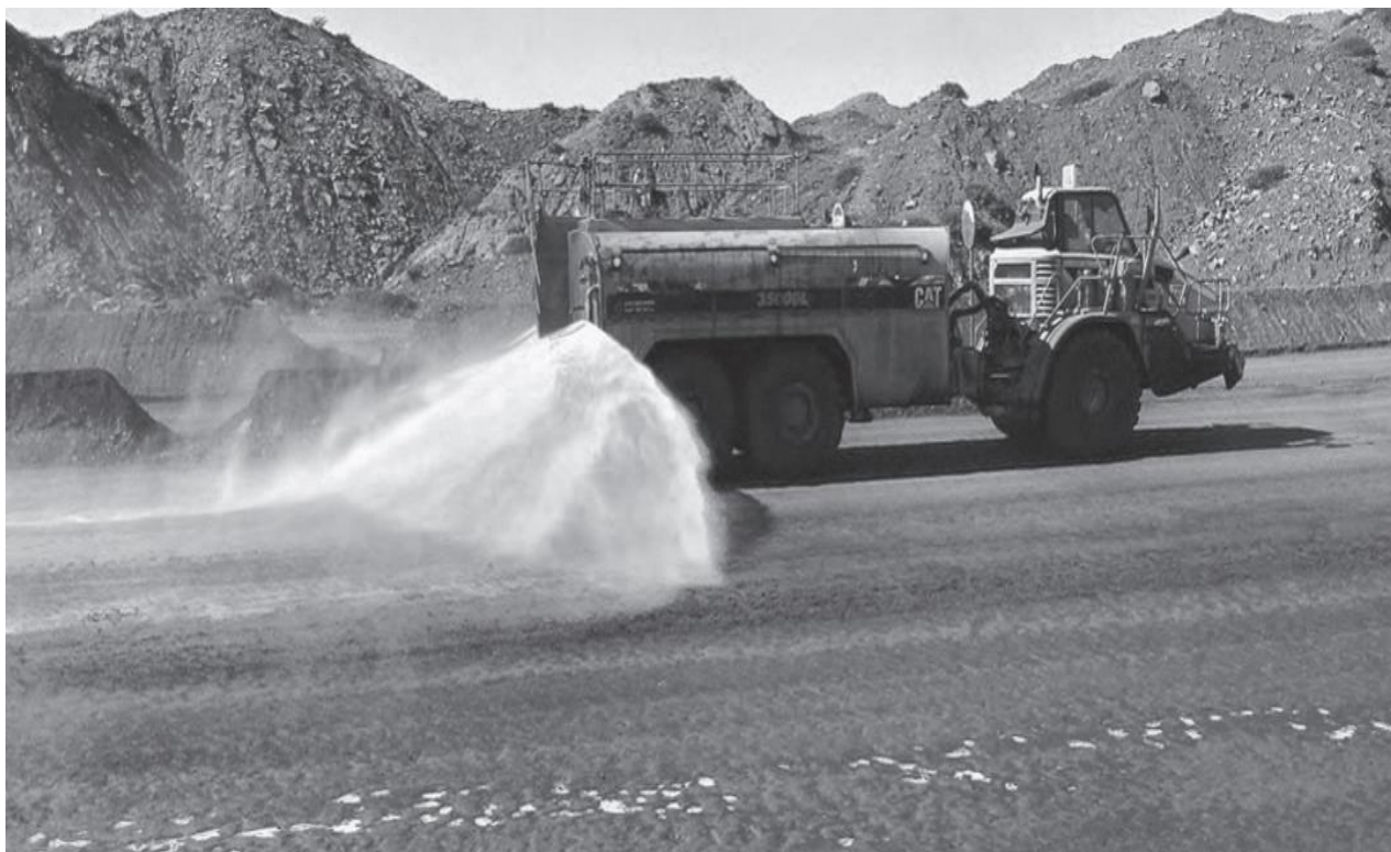
Рисунок 4.1. - Специальная оросительная машина, подающая воду со скоростью до 20 км/ч*
