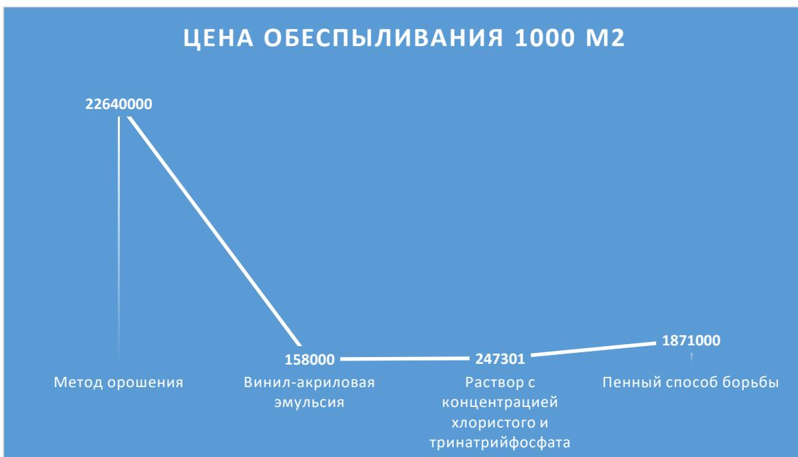
**Рис 4.3 - Сравнительная эффективность методов обеспыливания.**
