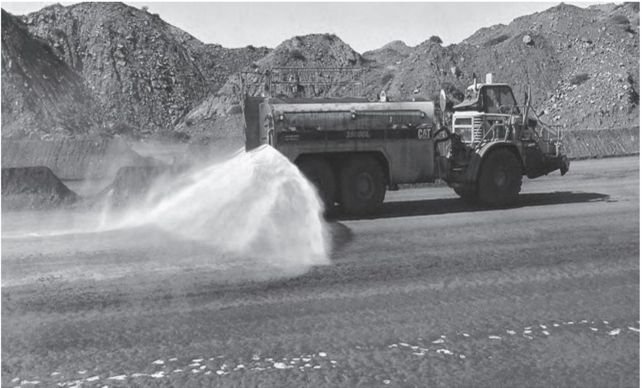
**Рис 4.1. - Специальная оросительная машина, подающая воду со скоростью до 20 км в час.**
