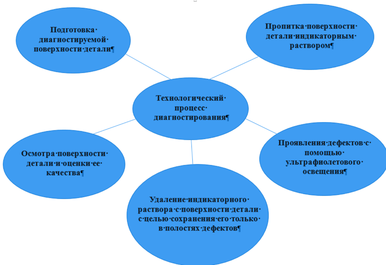
Рисунок. 2.2 - Основные операции технологического процесса диагностирования люминесцентным методом
