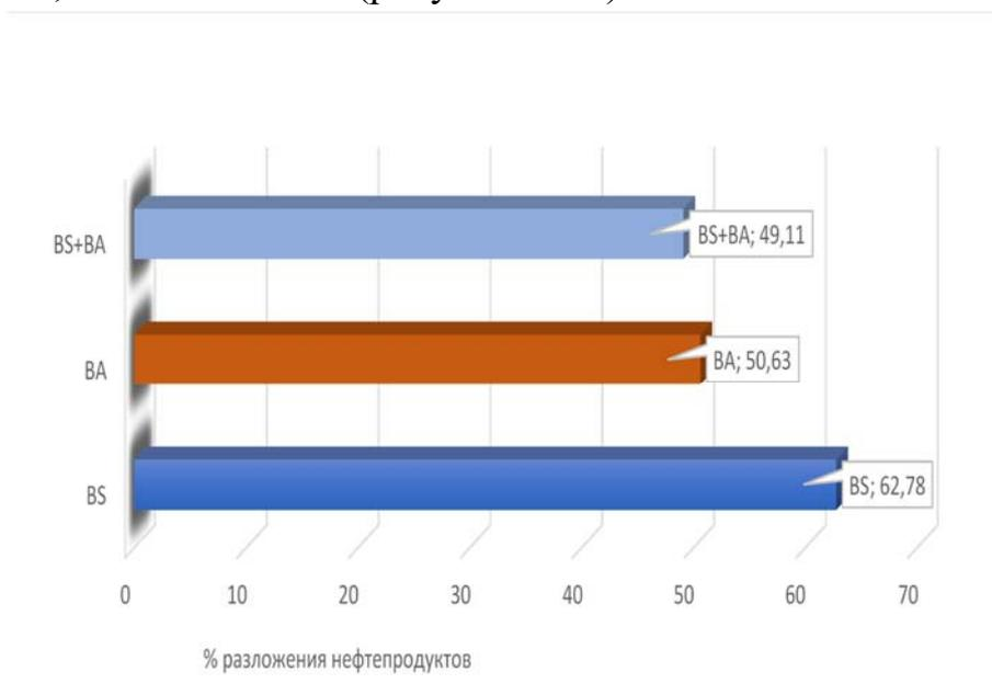
Рисунок 5.1.1 Рисунок 1. Разложение нефтепродуктов после 90 дней опыта, %. BS - биостимуляция; BA – биоаугментация.
