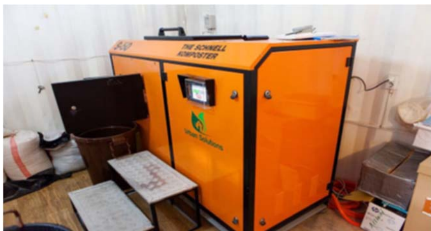
Рисунок 2.3.4 Компостер The Schnell, Model: S-50) Компостирование пищевых отходов производилось на аппарате THE SCHNELL KOMPOSTER (компания «Urban Solutions», Model S-50) (рисунок 2.3.4).
