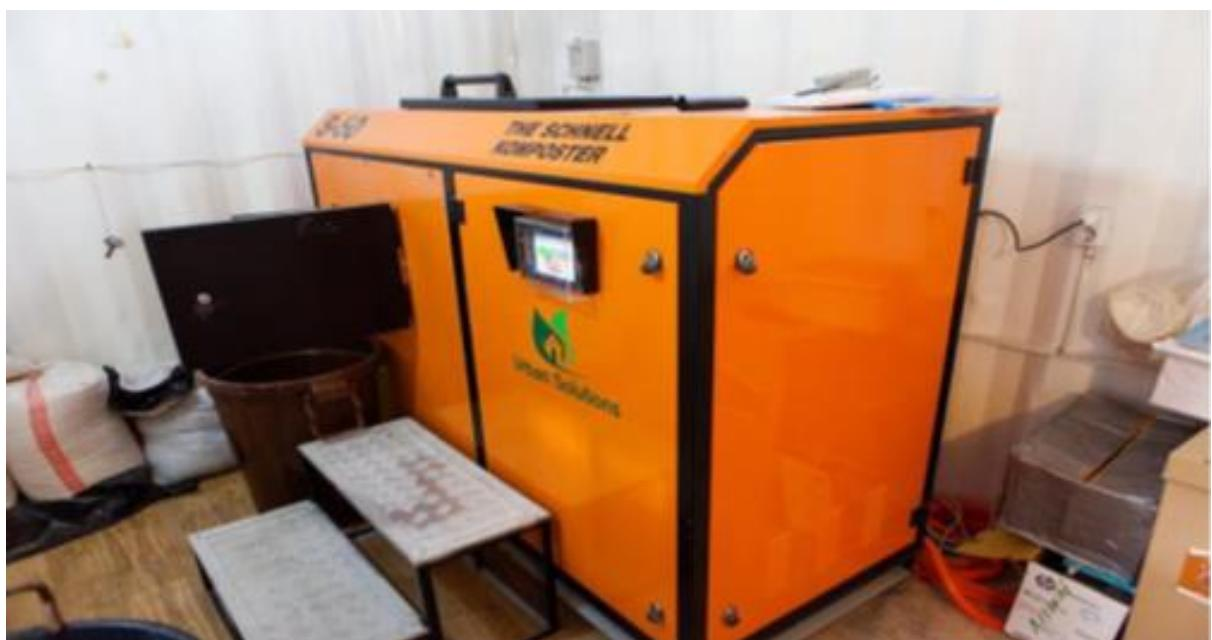
Рисунок 2.12 Компостер The Schnell, Model: S-50)
