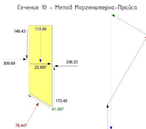
1-сүрөт. Секциянын (кесилген) тартылуу борборундагы горизонталдык сейсмикалык инерциялык күч
