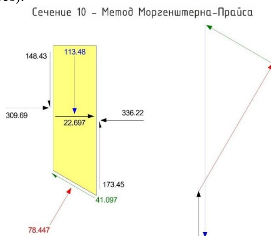
Рисунок 1. Горизонтальная сейсмическая инерционная сила в центре тяжести сечения (среза)
