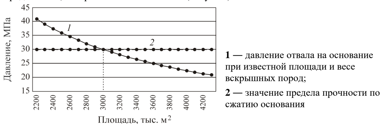
Рисунок 4. Зависимость площади основания отвала от давления складироваемых вскрышных пород:
