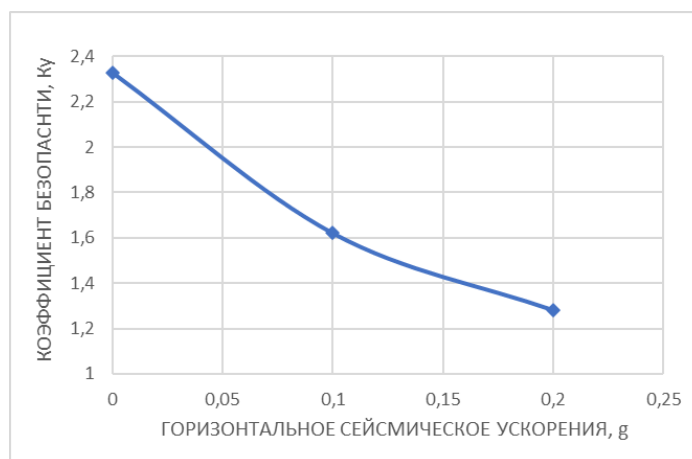
Рисунок 15 Коэффициент безопасности в зависимости от горизонтального сейсмического коэффициента.
