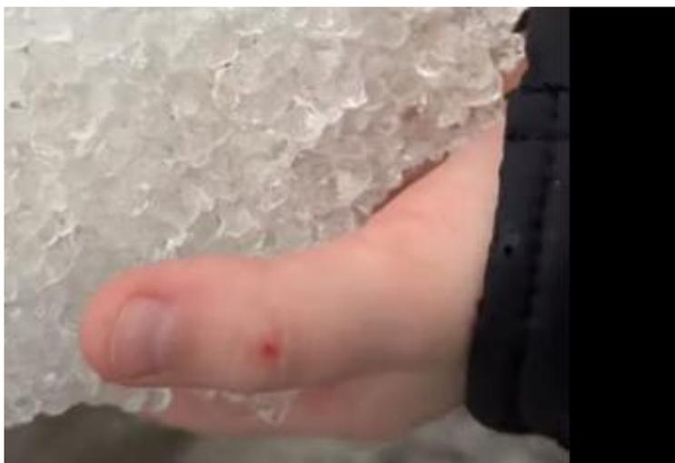
Рисунок 4.2.1 – Фрагмент материала шаровидной шуги, из реки Ала-Арча, при температуре воздуха ниже  $-17^{\circ}\text{C}$
