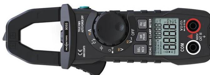
Рисунок 2.8 – Токоизмерительные клещи Richmeters 905S
