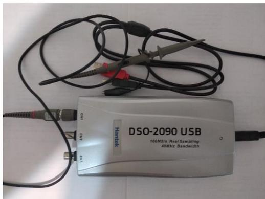
Рисунок 2.1 – Общий вид USB-осциллографа DSO-2090
