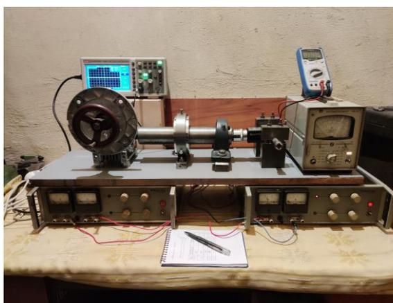
Рисунок 7.8 – Общий вид экспериментальной установки для тарирования датчика крутящего
