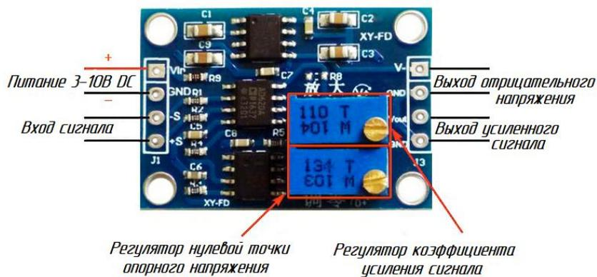
Рисунок 6.16 – Общий вид модуля усиления AD620
