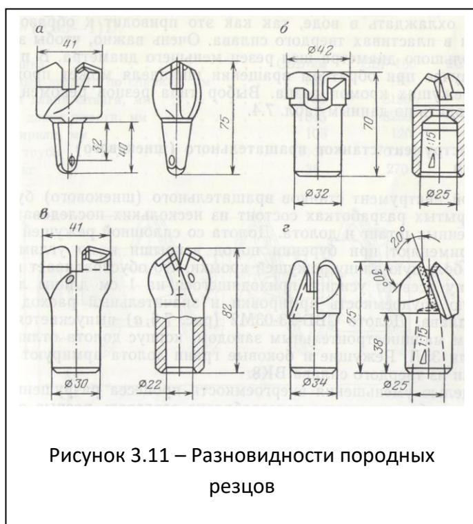
Породный резец БИ-741В (рисунок 3.11, в) позволяет бурить шпуры с промывкой колонковыми электросвёрлами в породах крепостью  $f < 8$ , осевое усилие при этом 10000-15000 Н. Режущая часть резца имеет отрицательный передний угол, равный  $15^\circ$ . При использовании таких резцов применяются шестигранные штанги. Соединение конусное, с углом конусности  $5^\circ$ .
