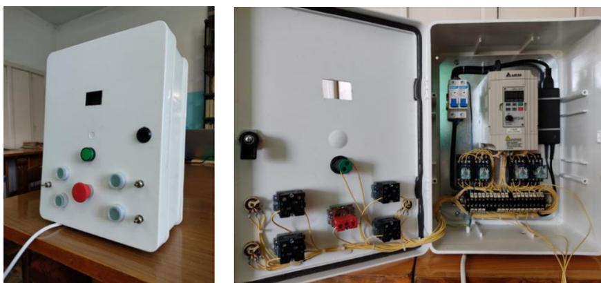
Рисунок 4.11 – Общий вид системы управления механизмом подачи инструмента буровой машины
