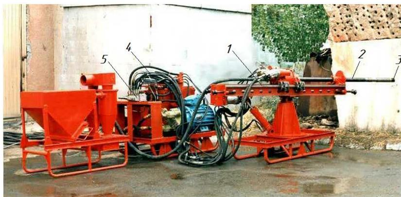
Рисунок 3.14 – Общий вид бурового станка КБ-76
