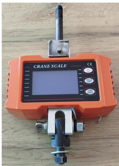
Рисунок 6.17 – Общий вид датчика осевой нагрузки ДОС-1
