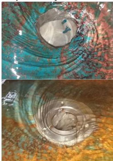
Рисунок 12 – Фрагменты образования гидроворонки при различных диаметрах отверстия верхний 85 мм, нижний 58 мм.
