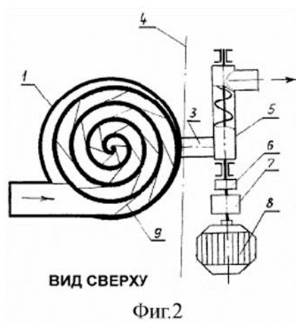
Рисунок 1.9 – Схема водовихревой микроГЭС
