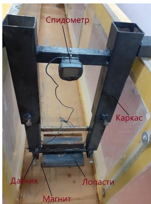
Рисунок 4.9 Вертушка для измерения скорости потока
