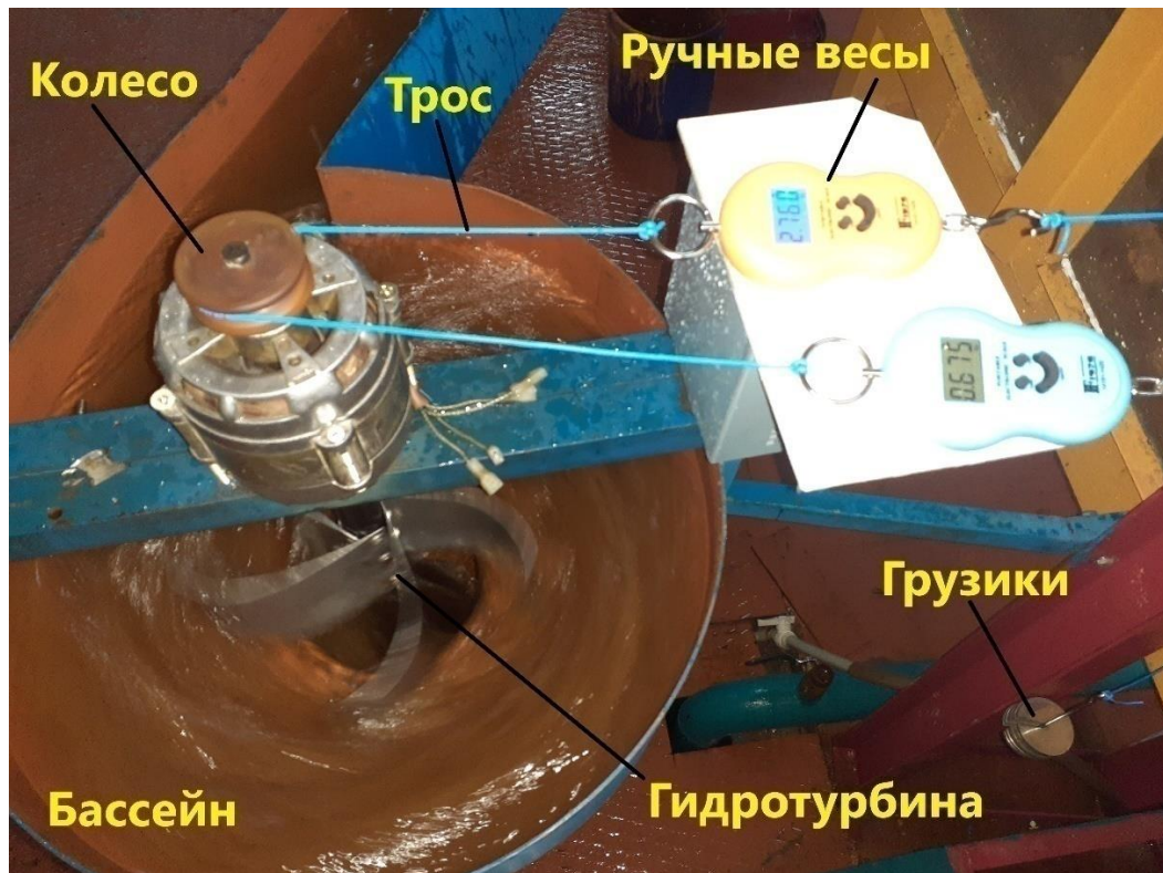
Рисунок 4.7 Система измерения момента
