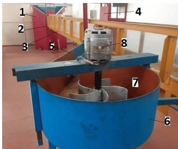
Рисунок 4.3 Действующий опытный образец экспериментального стенда 1 – основная ёмкость, 2 – подвижное соединение, 3 – основной лоток, 4 – шлюз, 5 – соединительный лоток, 6 – цилиндрический бассейн, 7 – гидротурбина, 8 – генератор.
