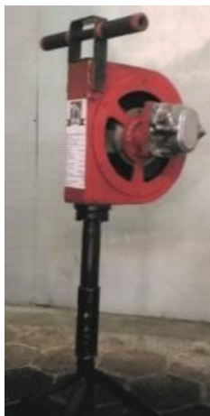
11 – сүрөт – Сокку механизми
