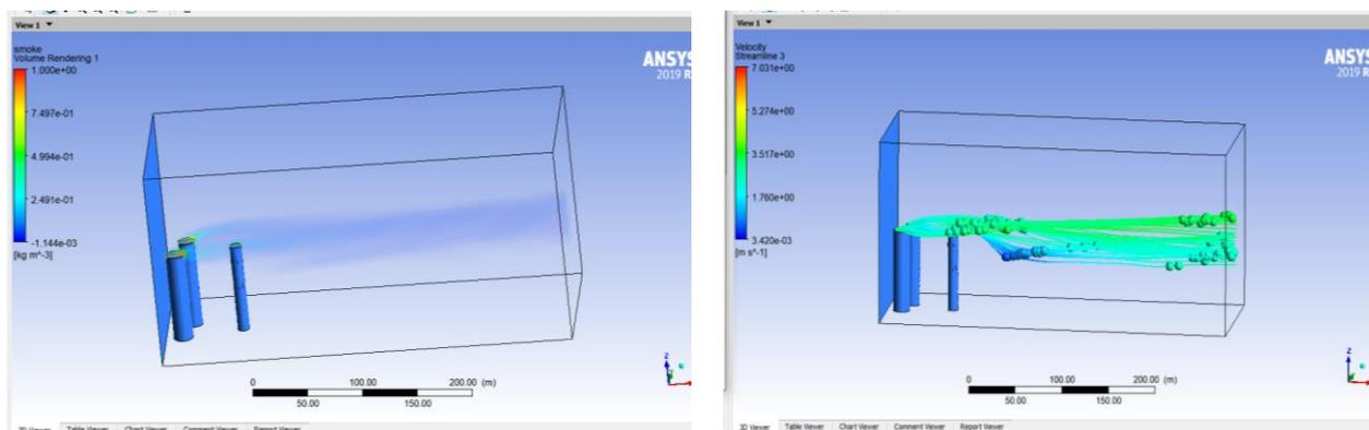
Рисунок 5. Определение условий нестационарного режима выбросов; задание параметров диффузионного переноса; визуализацию результатов в режимах Transparency и Streamline.
