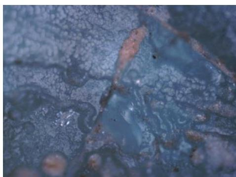
Рисунок 3.68 - Микроструктура глазури образца №11
