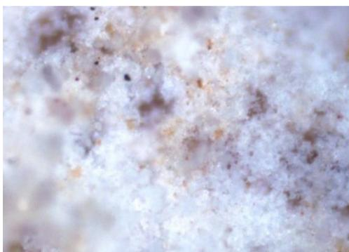
Рисунок 3.70 - Микроструктура глазури образца №16
