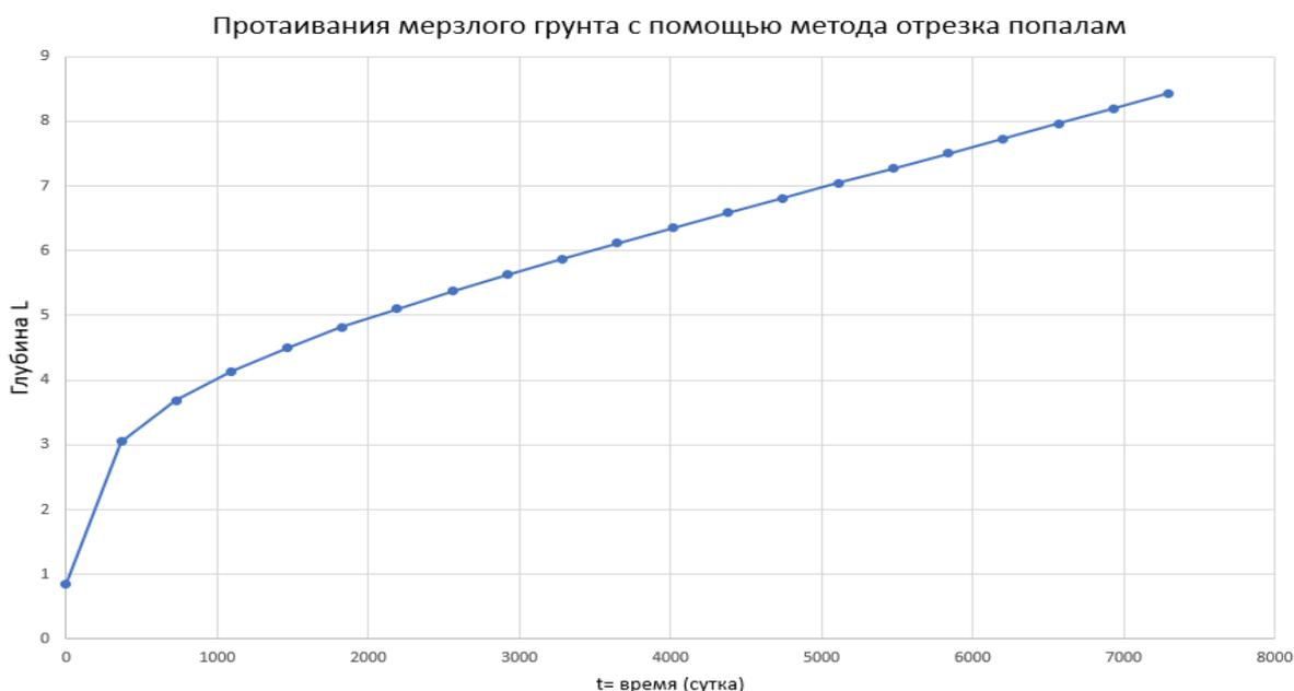
Рис.3.11 Глубина таяния как местоположение нулевой изотермы
