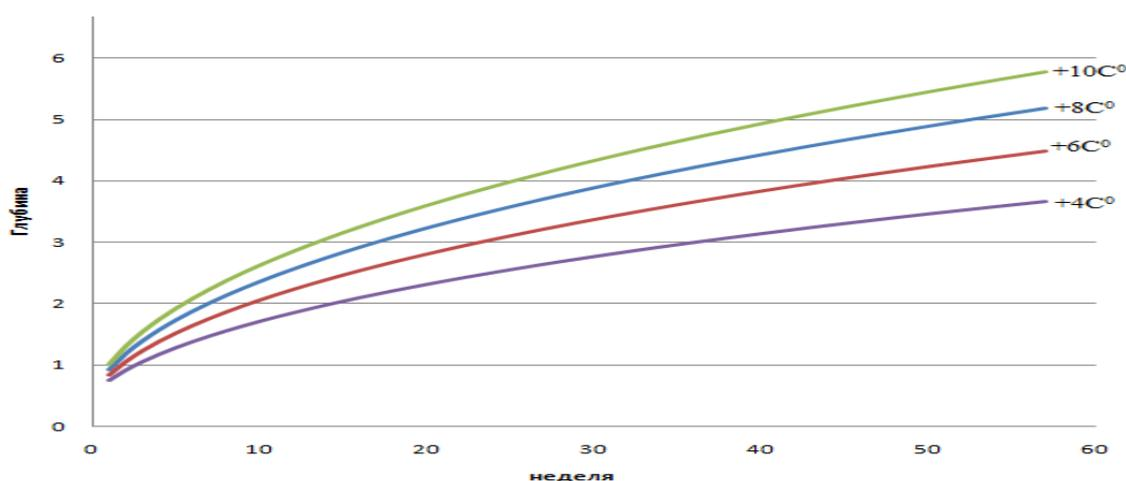
Рис. 2.3 Глубина таяния основание хвостохранилища в зависимости температуры воды.
