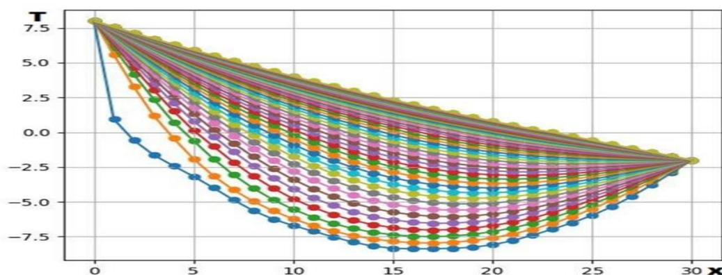
Рис.3.5. Ход изменения температуры грунта до установления процесса
