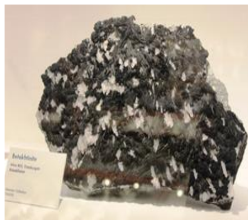
Рисунок 4- Контакт рудоносного песчаника (темно-черное) с пелитово-карбонатным материалом. Цемент пелитово-карбонатно-кремнистый
