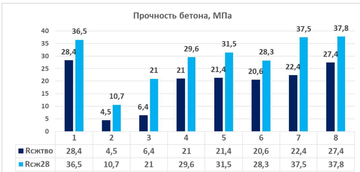
Рисунок 6.1 – Прочность  $R_{сж}^{твo}$  и  $R_{сж}^{28}$  мелкозернистого бетона на ЦЗШВи (30% ЗШС) и песке составов 1-8
