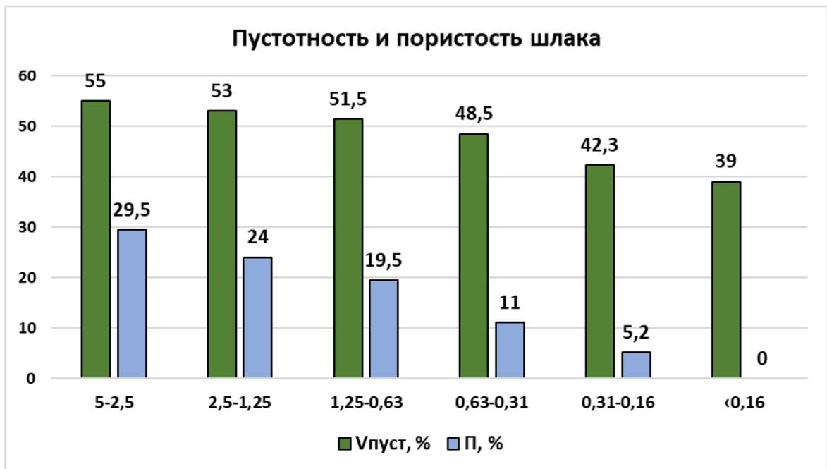
Рисунок 4.4 – Пустотность и пористость топливного шлака
