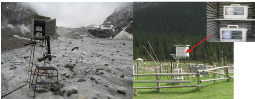
Рисунок 2.9. Фотодокумент. Метеорологическая будка с суточными самописцами температуры и влажности воздуха на леднике Кара-Баткак.
