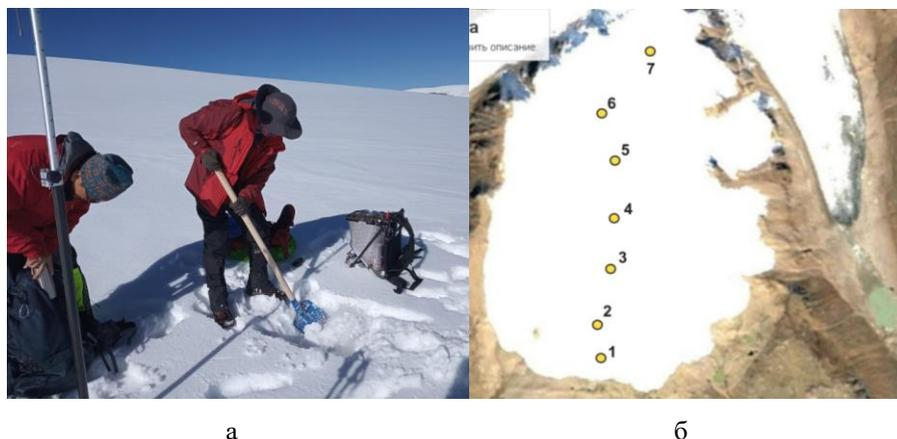
Рисунок 3.19. а) - фотодокумент установки абляционных реек.
