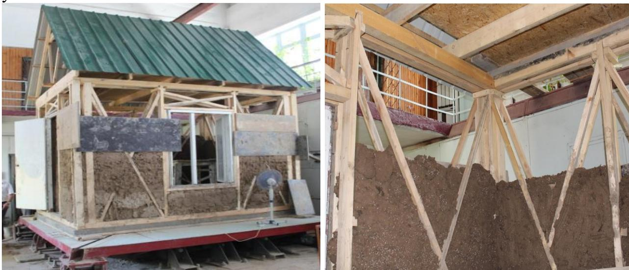
Рисунок 11 - Модель дома «сынч» и фрагмент его строительства
