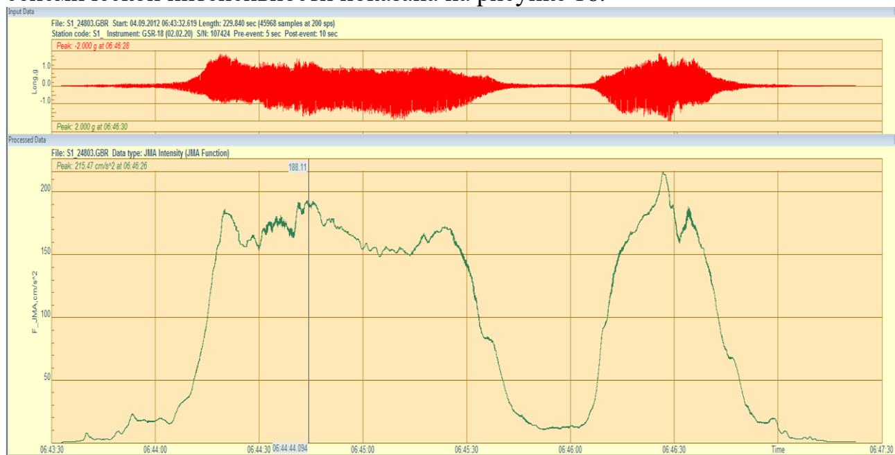
Рисунок 15 - Запись интенсивности (балльности) колебаний на уровне покрытия модели «сокмо». Разрушение соответствует  $188 \text{ см/с}^2$
