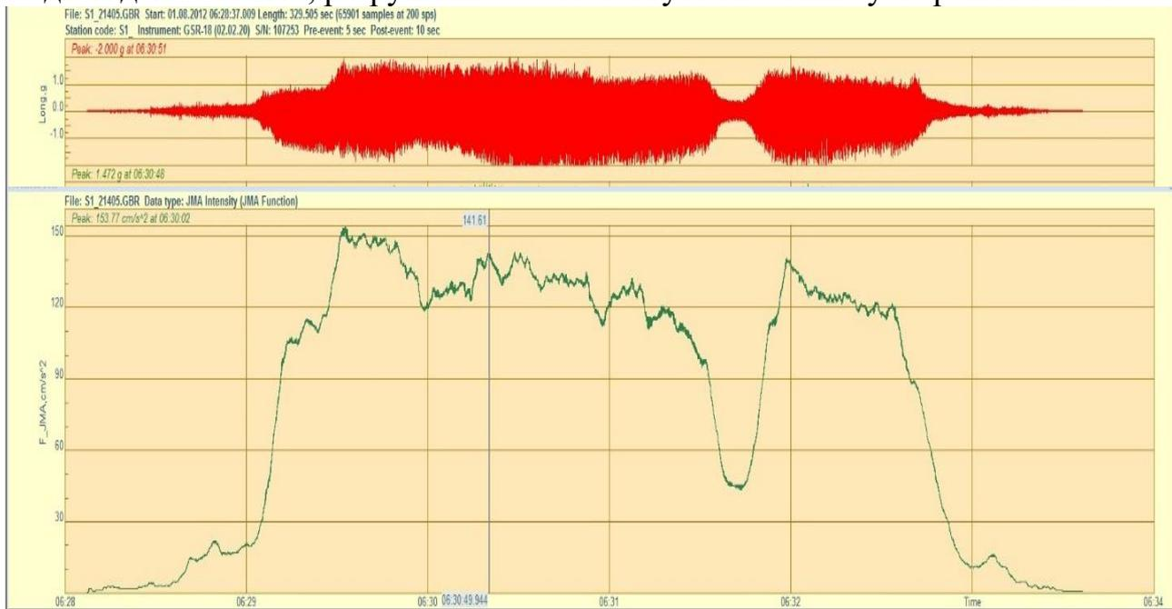
Рисунок 12 - Запись интенсивности колебаний на уровне покрытия модели «сынч»
