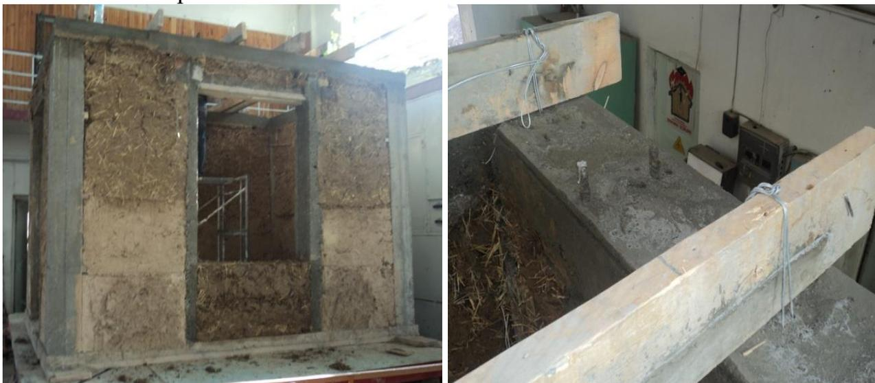
Рисунок 17 - Фрагмент модели дома железобетонного каркаса с глиняным заполнением
