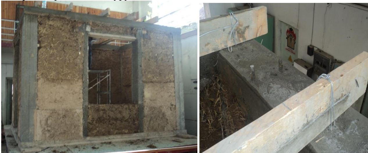
17-сүрөт.- Темир-бетон каркасы жана ылай-топурактан толтурулган үйдүн моделинин фрагменти.
