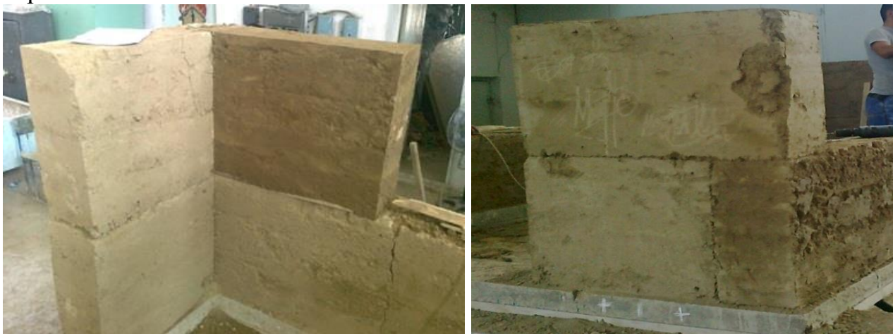
14-сүрөт. - «Сокмо» үйдүн дубал моделинин фрагменти.
