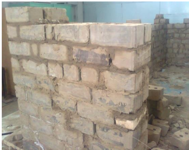
8-сүрөт. – Чийки кыштан салынган үйдүн моделинин көрүнүшү. а) аяктаган көрүнүш; б) дубалдын фрагменти.
