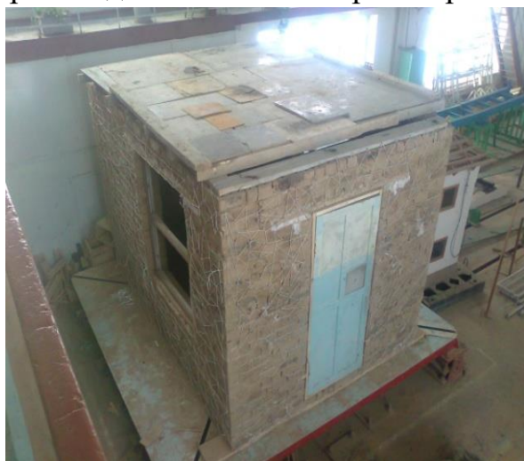
8-сүрөт. – Чийки кыштан салынган үйдүн моделинин көрүнүшү. а) аяктаган көрүнүш; б) дубалдын фрагменти.
