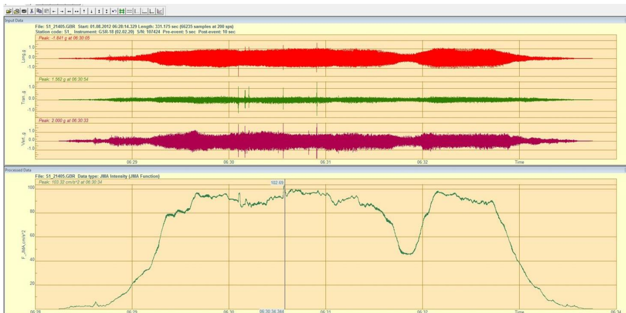
Рисунок 5.17 - Запись интенсивности колебаний сейсмоплатформы модели дома «сынч». Начало разрушения начинается на ускорении 103 \text{ см/с}^2 .
