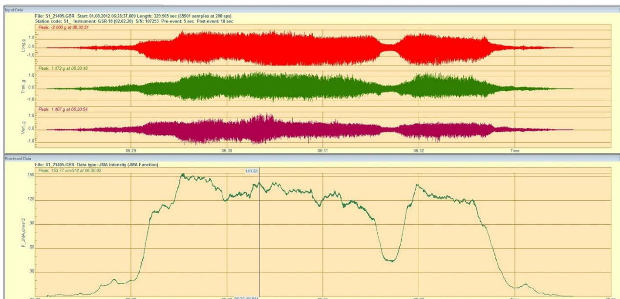
Рисунок 5.18 - Запись интенсивности колебаний на уровне покрытия модели «сынчевого» дома. Разрушение начинается на ускорении 142 \text{ см/с}^2 .
