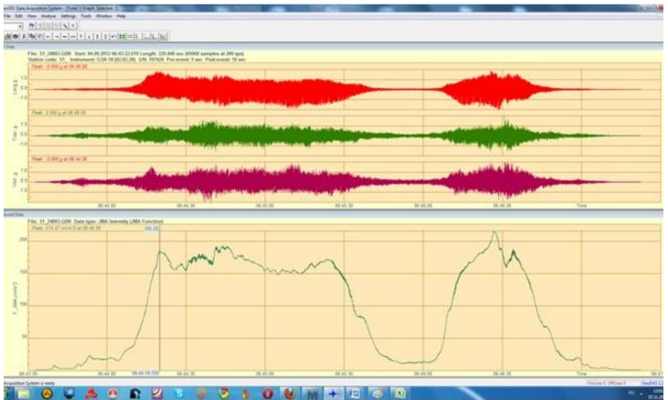
Рисунок 5.26 - Запись интенсивности (балльности) колебаний сейсмоплатформы модели дома «сокмо». Разрушение соответствует ускорению 185\text{см}/\text{с}^2 .
