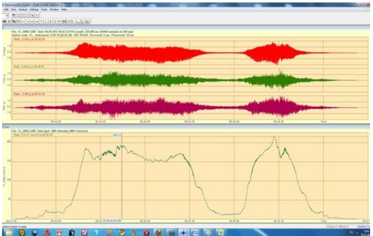
Рисунок 5.27 - Запись интенсивности (балльности) колебаний на уровне покрытия модели «сокмо». Разрушение соответствует ускорению 188\text{ см}/\text{с}^2 .
