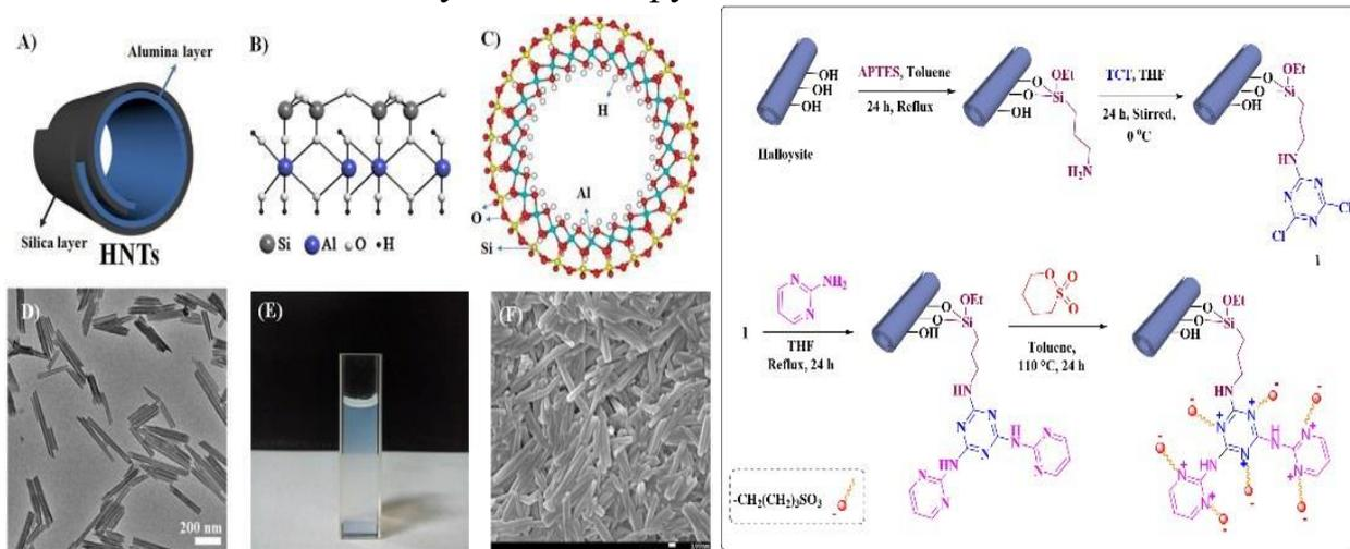
Рисунок 5. Схема строения галлуазитовой нанотрубки
