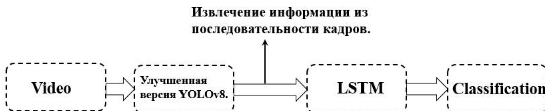
2-сүрөт. YOLOv8-LSTM моделинин блок-схемасы
