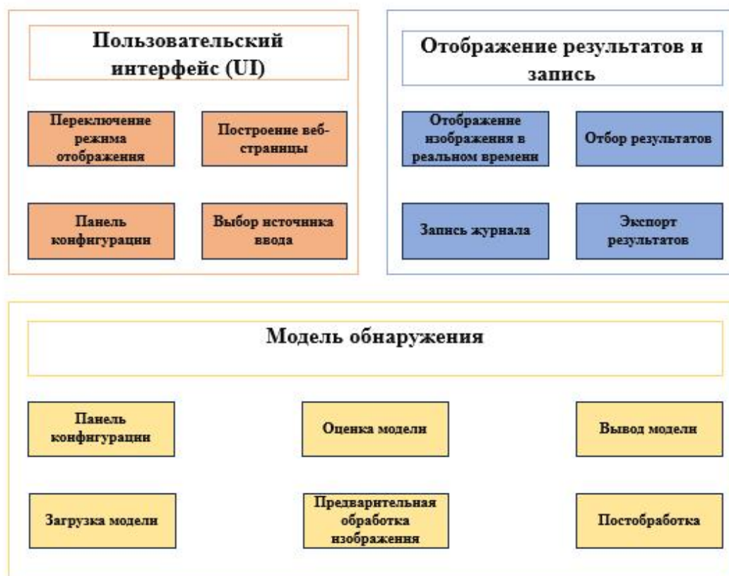
Рисунок 5. Схема построения архитектуры системы
