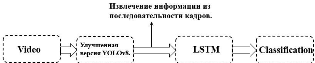
Рисунок 2. Блок-схема модели YOLOv8-LSTM
