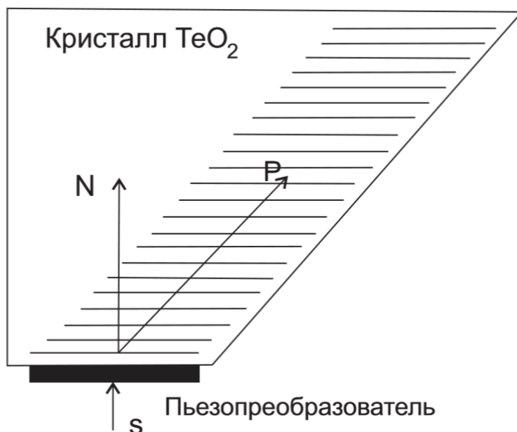
Рисунок 5.11. Схематическое представление ячейки Брэгга АОПФ со сном акустического пучка из-за анизотропии кристалла (случай неколлинеарного взаимодействия)
