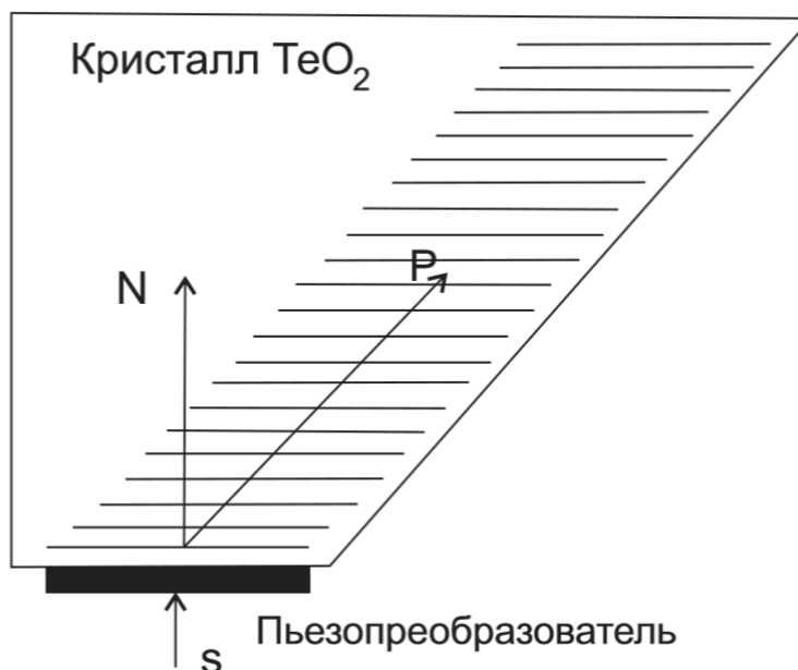
Рисунок 5.11. Схематическое представление ячейки Брэгга АОПФ со сносом акустического пучка из-за анизотропии кристалла (случай неколлинеарного взаимодействия)
