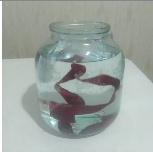
Рисунок 3.1.4 - Лента из 100 % хлопка, находится в стоячей воде на плаву, значить \rho_{\text{воды}} = \rho_{\text{лента}}
