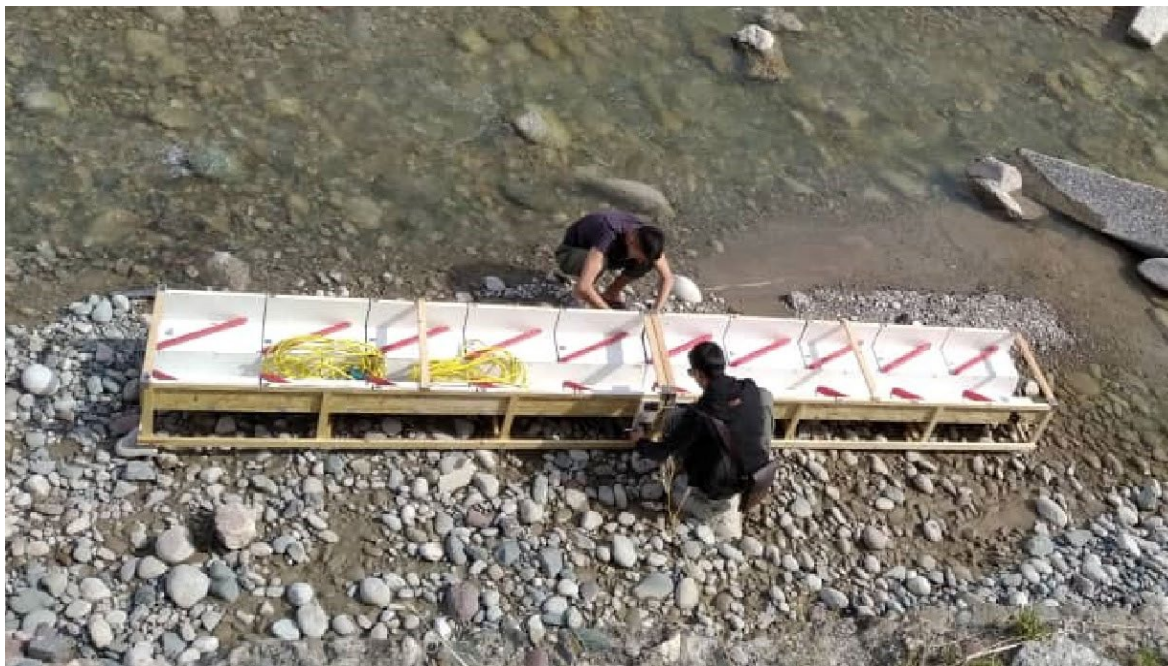
Рисунок 3.1.1 – Стыковка конструкций из двух частей экспериментального макета прямо на берегу реки Ала-Арча, длиной 5 м
