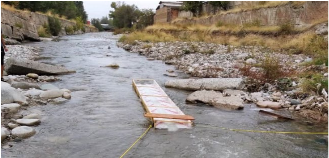
Рисунок 3.1.2. – Пробная погружения экспериментального макета натянутый по берегам реки веревками, с поиском участка различными режимами течения потока речной воды
