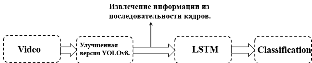
Рисунок 3.4. Блок-схема модели YOLOv8-LSTM
