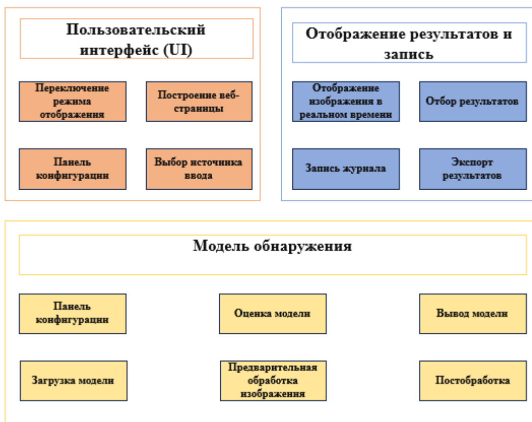
Рисунок 4.1. Схема построения архитектуры системы
