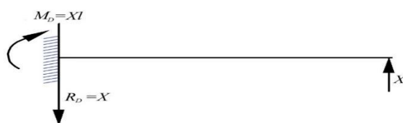
Рисунок 2.6.6 – Эквивалентная схема определения прогиба в точке В от действия силы Р.
