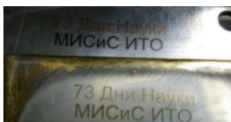
Рисунок 8 – Лазерная цветная маркировка хромистого покрытия
