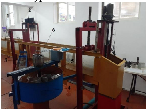
Рисунок 11 – Действующий опытный образец экспериментального стенда 1 – основной лоток, 2 – шлюз, 3 – соединительный лоток, 4 – цилиндрический бассейн, 5 – образующая воронка, 6 – генератор.
