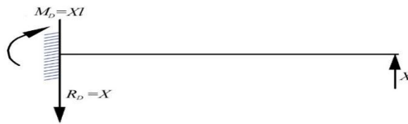
2.6.6-сүрөт – Р күчүнүн аракетинен алыс В чекитте ийилүүнү аныктоонун эквиваленттүү схемасы.
