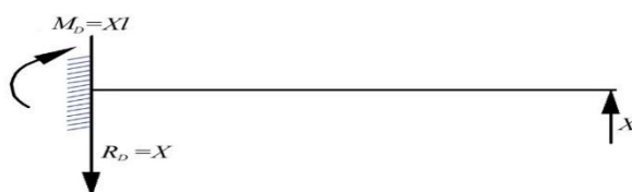
2.6.6-сүрөт – P күчүнүн аракетинен алыс В чекитте ийилүүнү аныктоонун эквиваленттүү схемасы.
