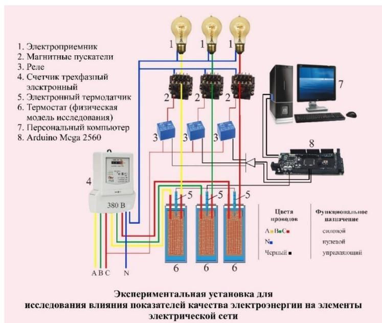
**Рис. 24. Экспериментальная установка для исследования физических процессов в электрических сетях: 1- электроприемник; 2- магнитные пускатели; 3- реле; 4 - счетчик трехфазный электронный; 5 -электронный датчик температуры; 6 термостат (физическая модель исследования); 7- ArduinoMega 2560; 8 -персональный компьютер.**
