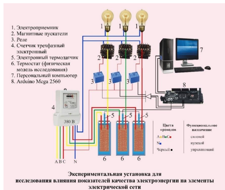
Рис. 5.3. Экспериментальная установка для исследования физических процессов в электрических сетях: 1- электроприемник; 2- магнитные пускатели; 3- реле; 4 - счетчик трехфазный электронный; 5 -электронный датчик температуры; 6 термостат
